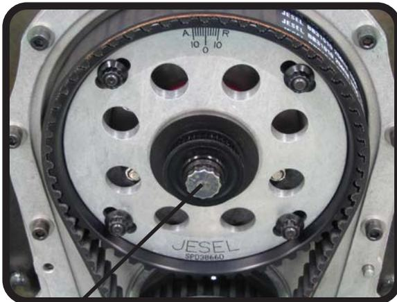
**CAM BOLT IS LH THREAD**
